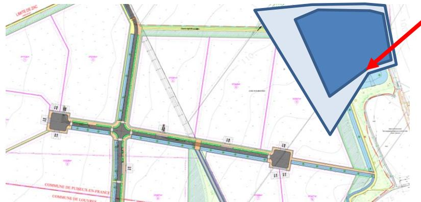
**Emprise du bassin nécessaire pour gérer la pluie cinquantennale et l'infiltration des pluies jusqu'à 8mm : surcoût des travaux de l'ordre de 2M€ HT (dénivelé existant de 8 à 10m) + impact sur les recettes attendues**
