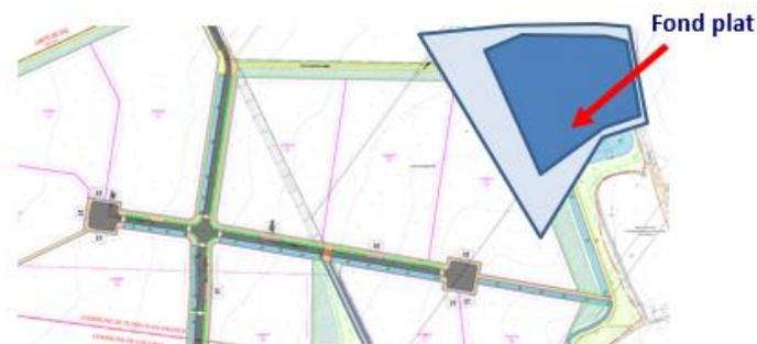
**Emprise du bassin nécessaire pour gérer la pluie cinquantennale et l'infiltration des pluies jusqu'à 8mm : surcoût des travaux de l'ordre de 2M€ HT (dénivelé existant de 8 à 10m) + impact sur les recettes attendues**
