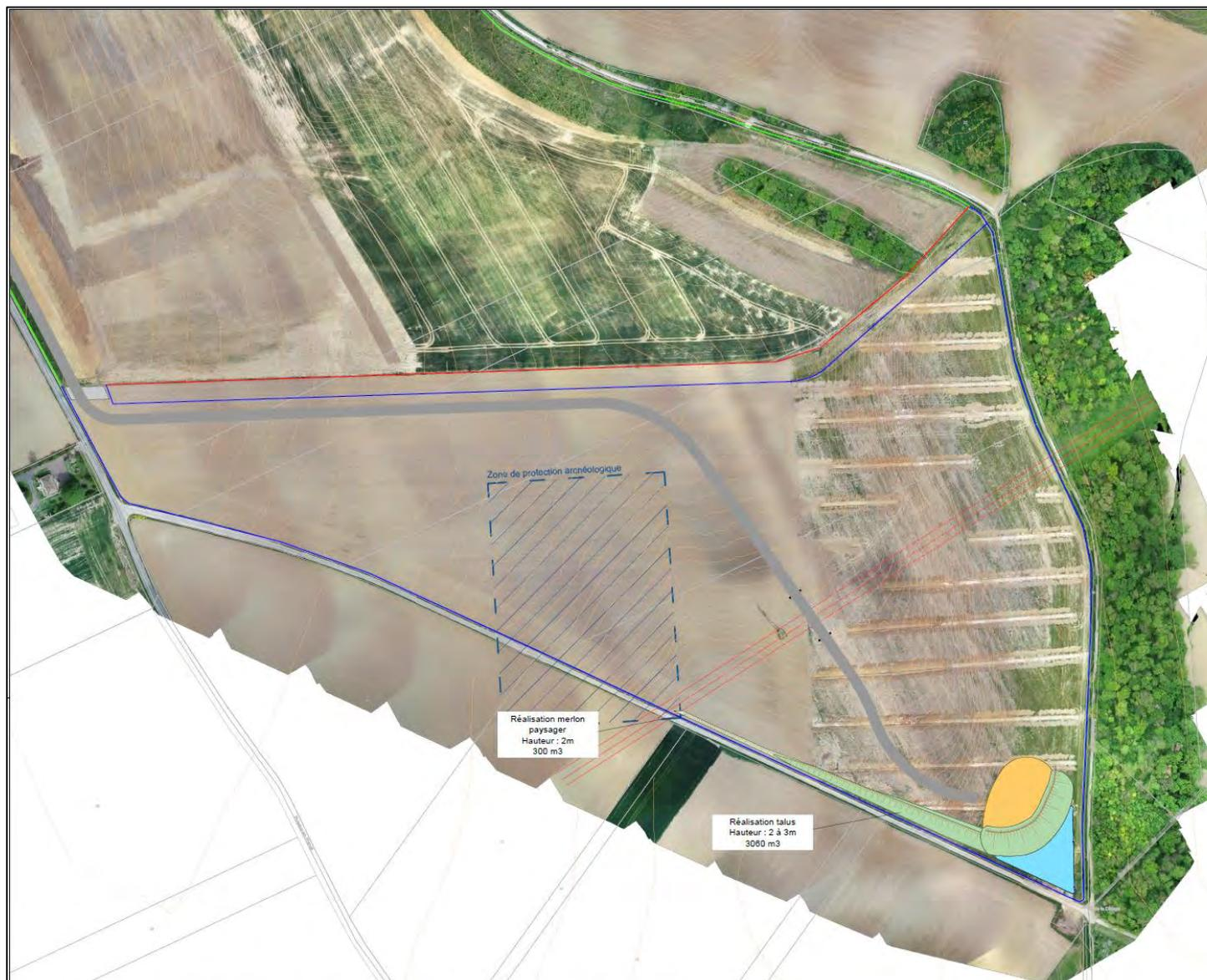
Phase 4 - Réalisation de la suite du talus (hauteur variable de 2 à 3m) et début de la réalisation du merlon paysager (hauteur 1m)
