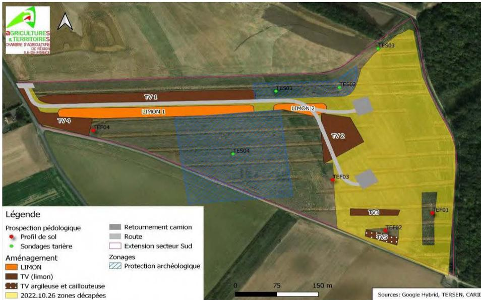
Figure 5 : avancement des travaux d'aménagement au 26 octobre 2022 et plan d'implantation des observations pédologiques
